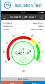
センサやケーブルが装置に組込まれた状態でも、アンプ代わりに本製品を接続する形で絶縁状態をチェックし、結果を保存可能。
